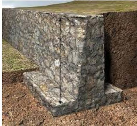
*Figura 3: Muro de contenção de concreto ciclópico.*
