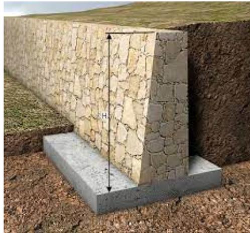
*Figura 2. Contenção de alvenaria de pedra.*
