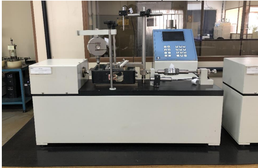
FIGURA 20 – PRENSA DE CISALHAMENTO DIRETO (VJ TECH) UTILIZADA NOS ENSAIOS
