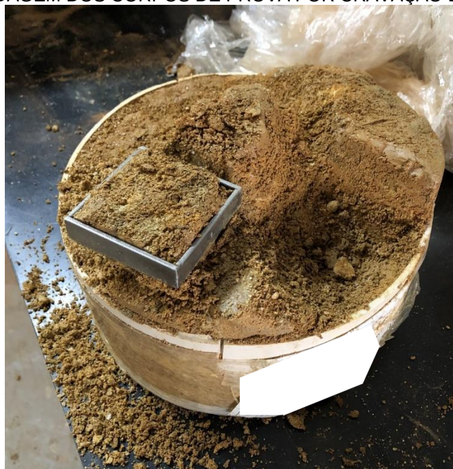
FIGURA 23 – MOLDAGEM DOS CORPOS DE PROVA POR CRAVAÇÃO DE ANEL METÁLICO
