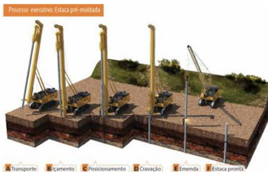
FIGURA 15 – CRAVAÇÃO DE ESTACA PRÉ-FABRICADA EM CONCRETO
