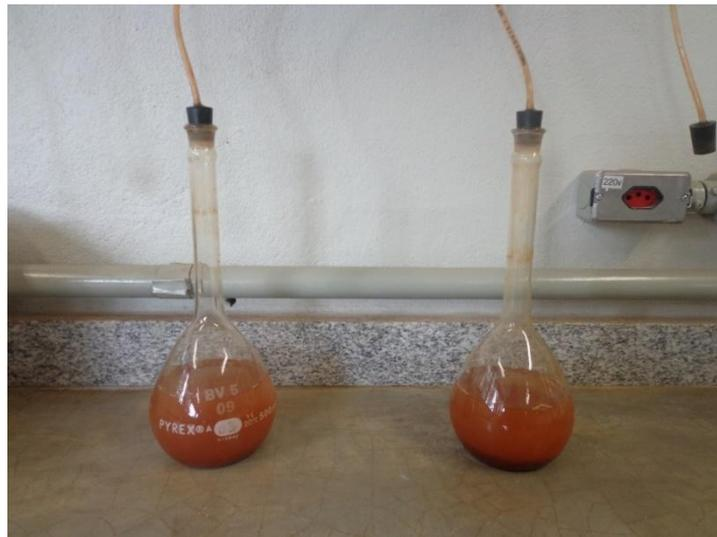
**Figura 5-** Ensaio de massa específica pelo método do picnômetro de vidro e da bomba de vácuo. (Fonte: Laboratório de Mecânica dos Solos – NUGEO/UFOP)
