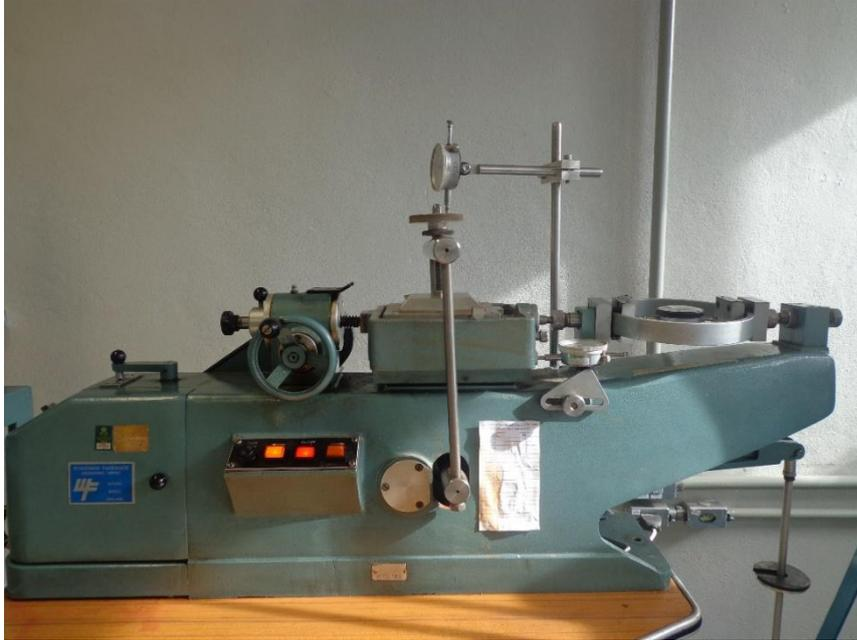
**Figura 9-** Ensaio de cisalhamento direto. (Fonte: Laboratório de Ensaio Especiais – NUGEO/UFOP)
