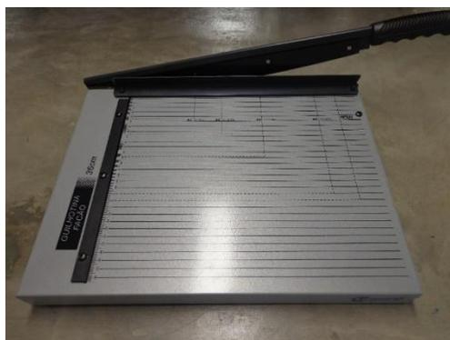
**Figura 11-** Guilhotina utilizada na confecção das fibras. (Fonte: Laboratório de Mecânica dos Solos – NUGEO/UFOP)
