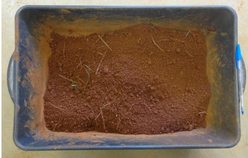
**Figura 14-** Solo utilizado no estudo com a adição das fibras de garrafas PET na proporção de 5 kg de solo para 20 g de fibras.
