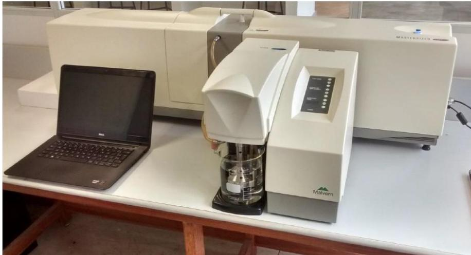
**Figura 6-** Granulômetro a laser. (Fonte: Laboratório de Ensaios Especiais – NUGEO/UFOP)
