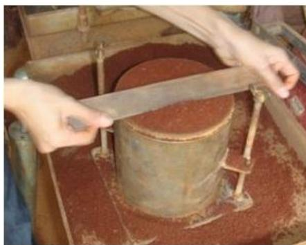
**Figura 7-** Ensaio de compactação. (Fonte: Laboratório de Mecânica dos Solos – NUGEO/UFOP)
