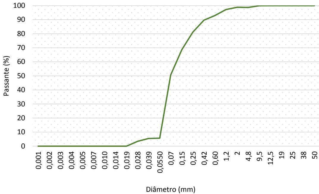
**Figura 15-** Ensaio de granulometria por peneiramento e sedimentação sem a adição de defloculante.
