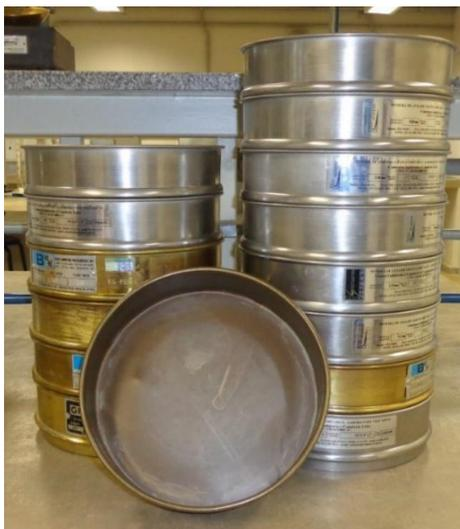
**Figura 1-** Peneiras utilizadas no ensaio de granulometria por peneiramento. (Fonte: Laboratório de Mecânica dos Solos – NUGEO/UFOP)
