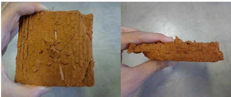
**Figura 31-** Corpo de prova, moldado com solo reforçado, cisalhado com uma tensão aplicada de 100 kPa.
