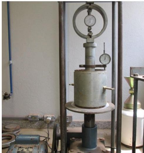
**Figura 8-** Ensaio de Índice de Suporte Califórnia. (Fonte: Laboratório de Mecânica dos Solos – NUGEO/UFOP)
