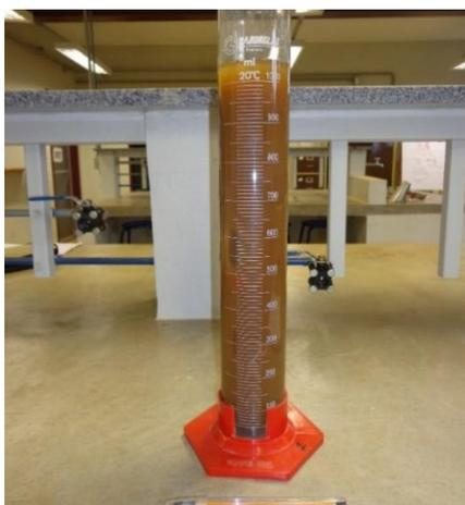
**Figura 2-** Ensaio de granulometria por sedimentação. (Fonte: Laboratório de Mecânica dos Solos – NUGEO/UFOP)
