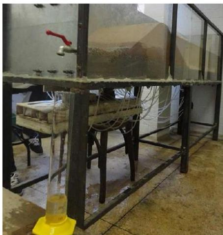
FIGURA 17 – MEDIÇÃO DA VAZÃO DE ÁGUA PELO MODELO REDUZIDO
