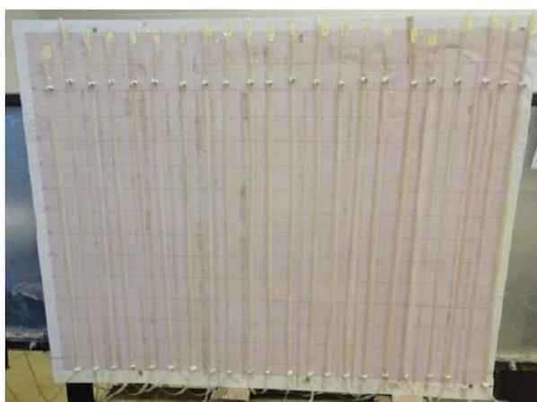
FIGURA 15 – PAINEL DE LEITURA DAS CARGAS PIEZOMÉTRICAS
