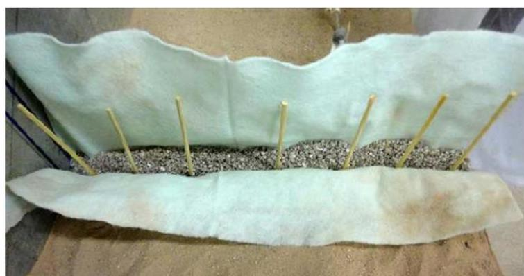
FIGURA 19 – CONSTRUÇÃO DO FILTRO VERTICAL
