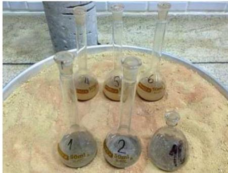
FIGURA 13 – DETERMINAÇÃO DA MASSA ESPECÍFICA COM PICNÔMETROS
