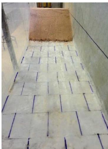
FIGURA 20 – MEMBRANA IMPERMEÁVEL DE MONTANTE
