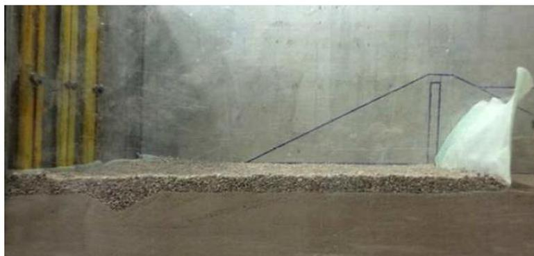
FIGURA 18 – MATERIAL DE FUNDAÇÃO E TAPETE HORIZONTAL
