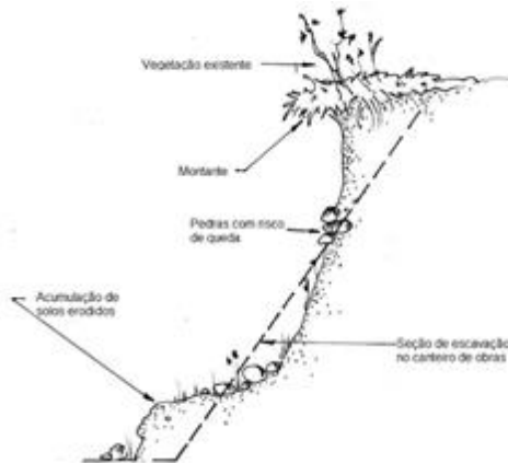
FIGURA 34 – PERFIL DO TALUDE A SER REGULARIZADO
